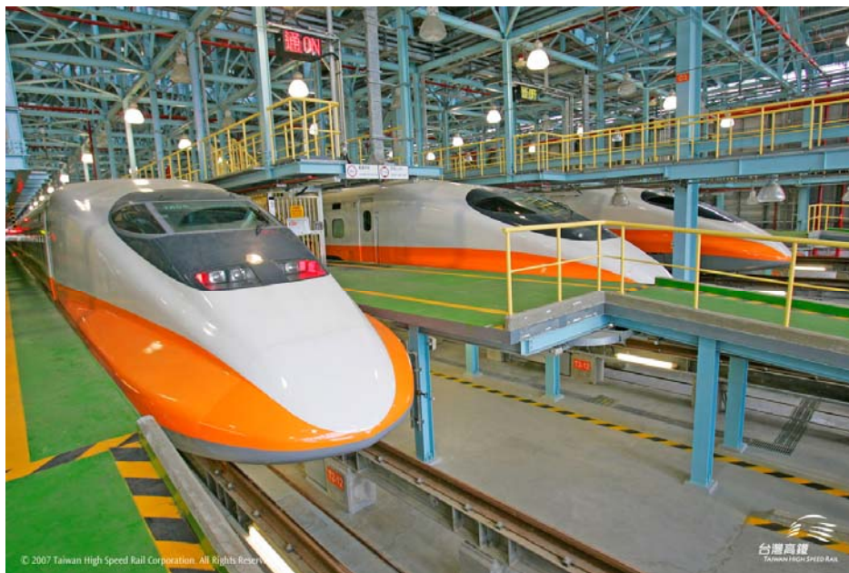
Depo Zhuoing umožňuje údržbu ve třech úrovních
