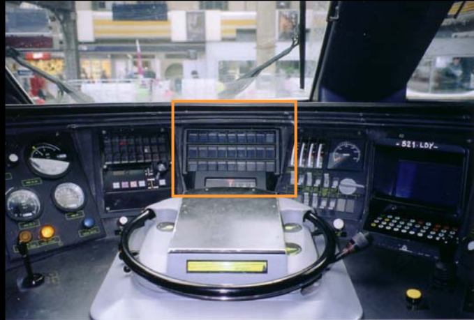
stanoviště TGV Réseau s panelem TVM (uprostřed)
