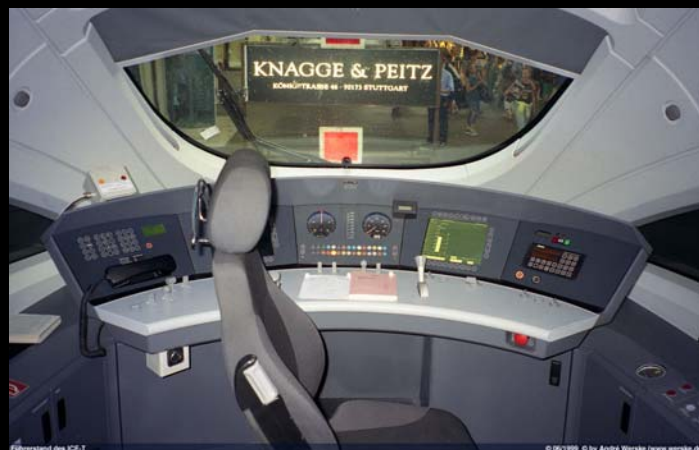
stanoviště strojvedoucího ICE-T s prvky LZB (uprostřed)
