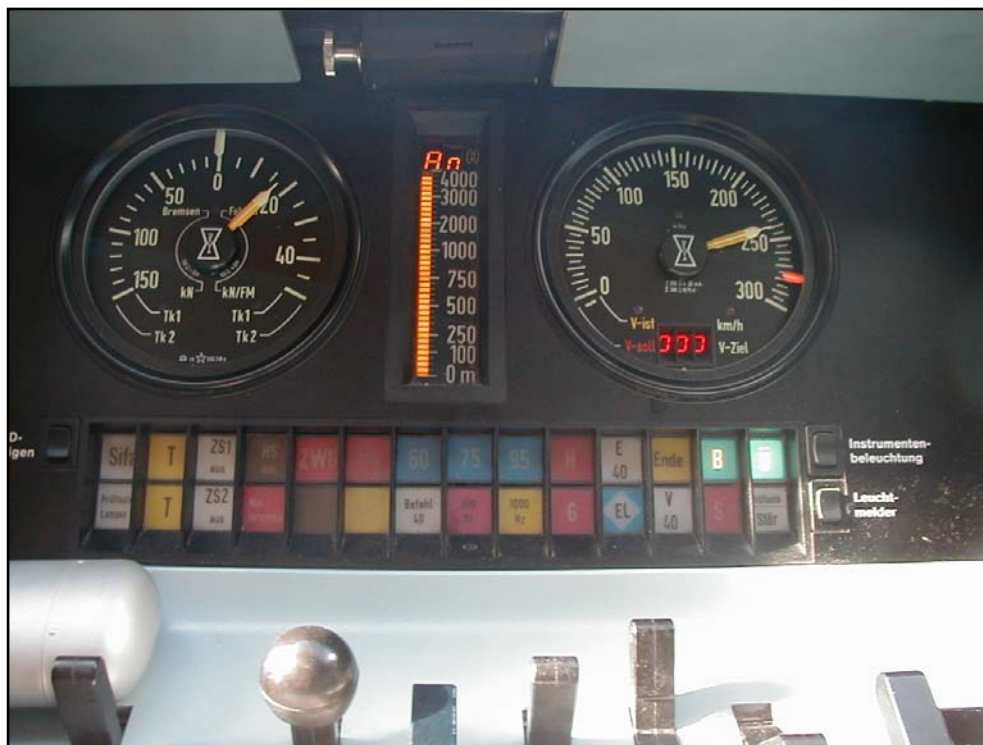
Obr.3 – zařízení MFA se zobrazením informací od LZB
