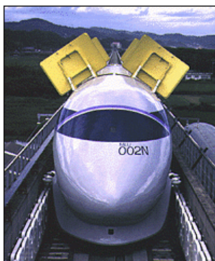
Obr. 9.: MLU002N s vysunutými aerodynamickými brzdami
