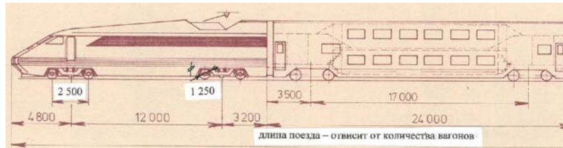
Obr. 11 Návrh hlavového vozidla Škoda Duplex pro SSSR z roku 1991. Zdroj: F. Palík, Progressivní řešení vysokorychlostních železničních vozidel a možnosti vysokorychlostní železnice v ČR, 2008
