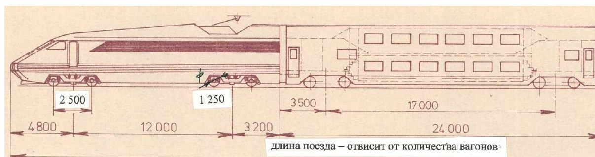
Obr. 11 Návrh hlavového vozidla Škoda Duplex pro SSSR z roku 1991. Zdroj: F. Palík, Progresivní řešení vysokorychlostních železničních vozidel a možnosti vysokorychlostní železnice v ČR, 2008
