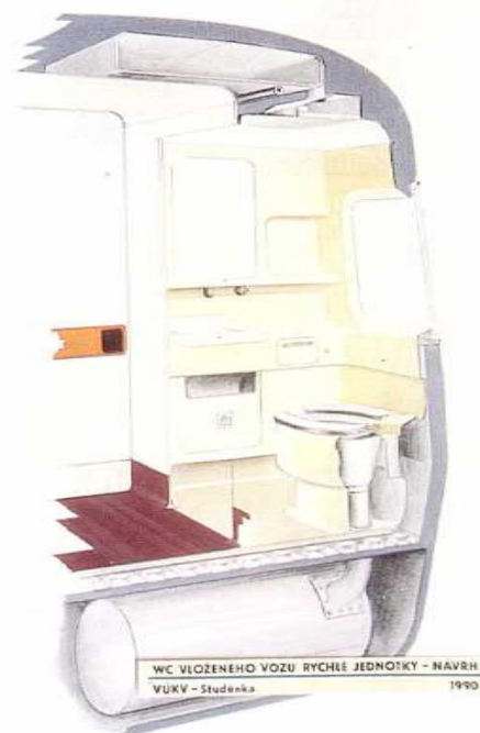
Obr. 3 Návrh vnitřního uspořádání jednopodlažního vysokorychlostního vozu, zpracovaný VÚKV v roce 1990. Zdroj: F. Palík, Vysokorychlostní vlaky ČSD
