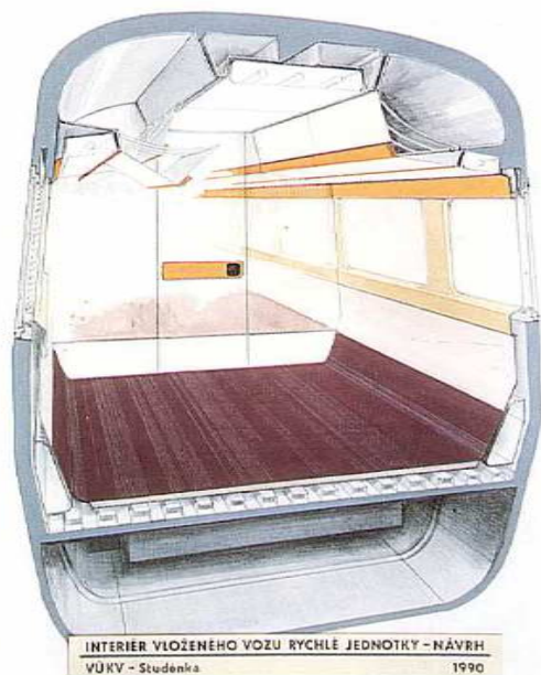
Obr. 3 Návrh vnitřního uspořádání jednopodlažního vysokorychlostního vozu, zpracovaný VÚKV v roce 1990. Zdroj: F. Palík, Vysokorychlostní vlaky ČSD
