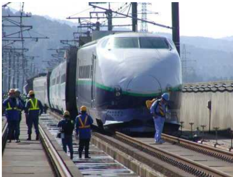
Obrázek 4. Vykolejení soupravy na trati Jeotsu [7]
